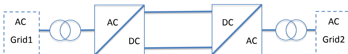
Σχήμα 4.3: Τυπική τοπολογία διασύνδεσης HVDC-LCC
