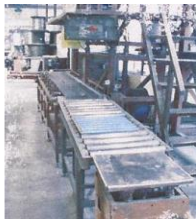
Εικόνα 22 Ταινιόδρομος για μεταφορά αντικειμένων σε βιομηχανία
