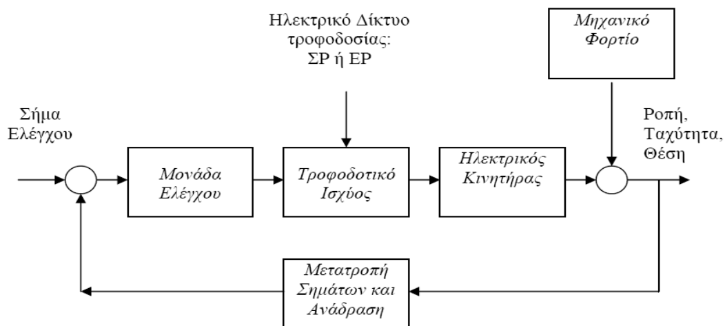
Εικόνα 3 Ελεγχόμενο Ηλεκτρικό Σύστημα
