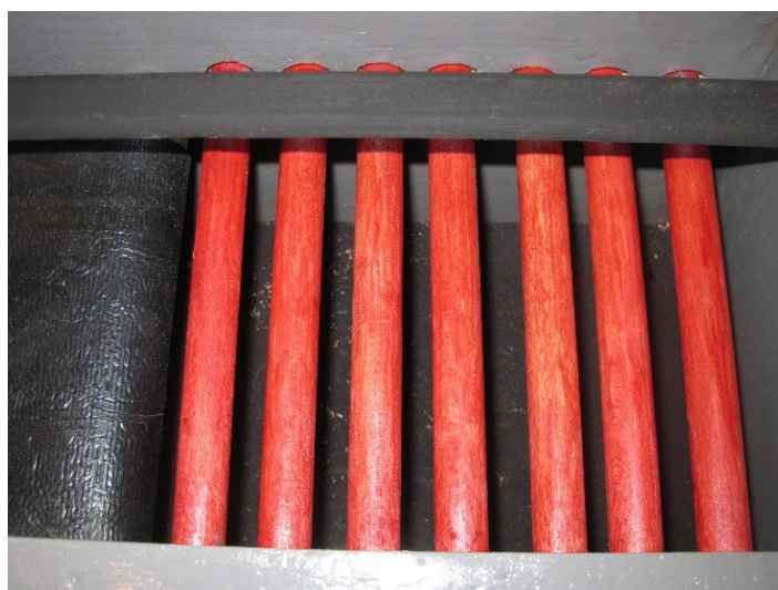
Εικόνα 31 Ράουλα στην έξοδο του συστήματος
