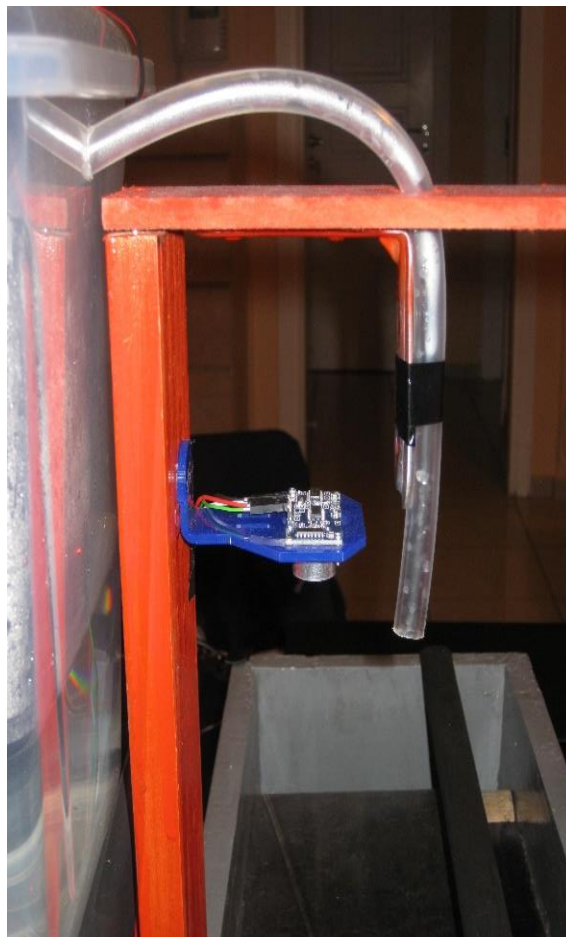
Εικόνα 37 Ο σωλήνας προέκτασης σταθεροποιήθηκε σε ένα ειδικά διαμορφωμένο πλαίσιο
