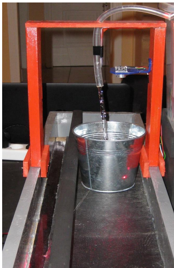
Εικόνα 57 Ο "cm1" μετρά τη στάθμη του δοχείου
