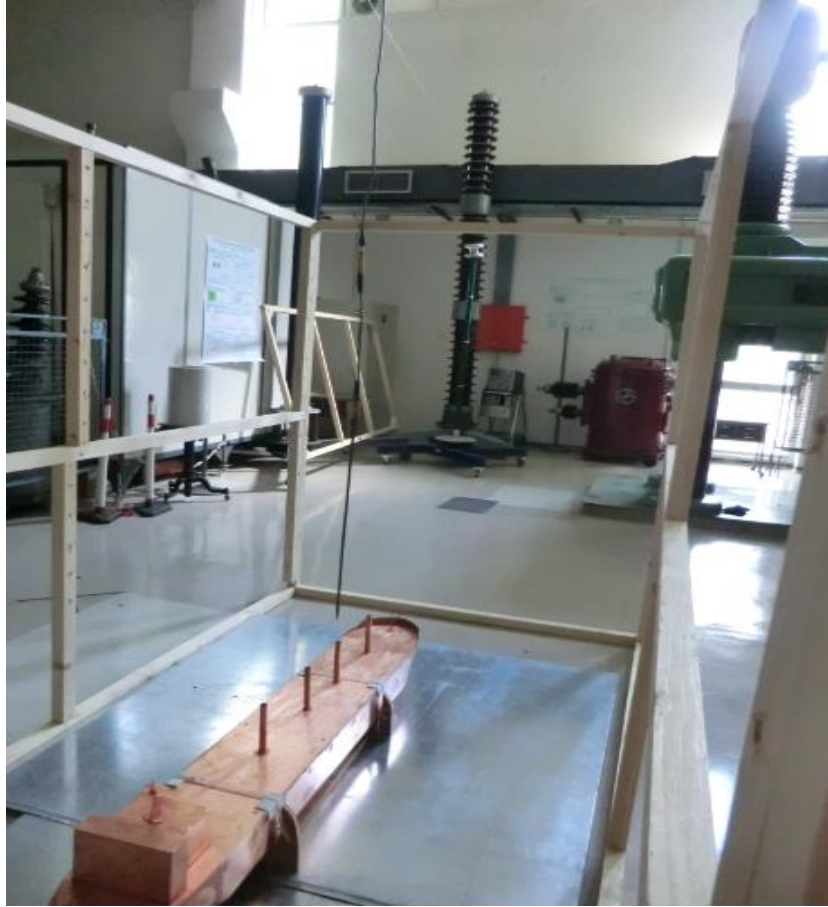
Σχήμα 4.6: Στο σχήμα φαίνονται το μοντέλο πλοίου, η μεταλλική πλάκα, η ράβδος και η ξυλοκατασκευή για το τοροειδές.
