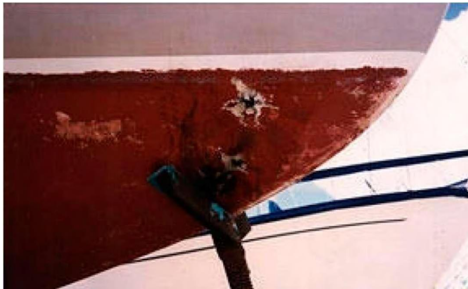
Σχήμα 3.1: Εκτεταμένες βλάβες στο κουφάρι πλοίου λόγω ανάπτυξης παράπλευρων εκκενώσεων μεταξύ της αλυσίδας της άγκυρας και του νερού [20].
