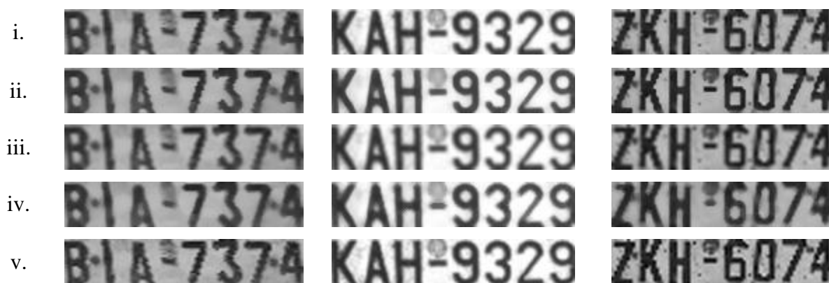
Εικόνα 4.3. i. αρχική εικόνα , ii. υπερερατό (bilateral) φίλτρο , iii. φίλτρο μέσου όρου (mean) μεγέθους 3 , iv. φίλτρο διαμέσου (median) 5, v. γκαουσιανό φίλτρο (Gaussian) με \sigma=0,35
