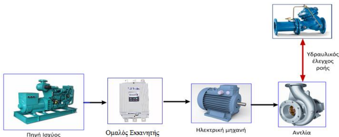
Σχήμα 1.1. Διάγραμμα συστήματος ελέγχου ροής αντλίας.
