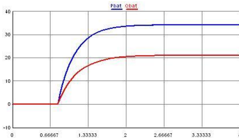
Εικόνα 5.44 Ροή ενεργού και αέργου ισχύος από τον αντιστροφέα μπαταριών κατά την μετάβαση από συνδεδεμένη σε νησιδοποιημένη λειτουργία του μικροδικτύου (οριζόντιος άξονας: χρόνος, κάθετος άξονας: ισχύς σε KW και KVar)
