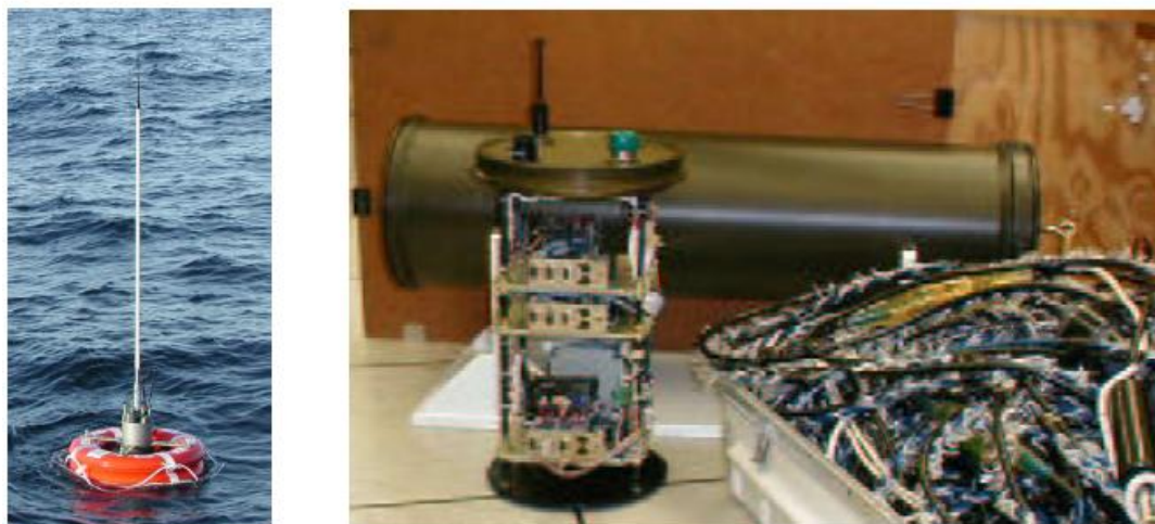
Σχήμα 2.5 gateway Σημαδούρα racom (αριστερά) και κόμβος DADS (δεξιά)
