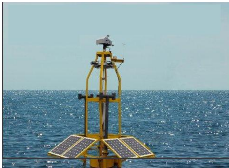
Σχήμα 2.9 Κόμβος συστήματος AMASS. Διακρίνεται η θερμική κάμερα και τα ηλιακά πάνελ τροφοδοσίας.
