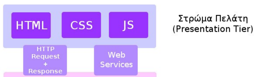
Σχήμα 4.7: Το Στρώμα Πελάτη και οι τεχνολογίες που χρησιμοποιήθηκαν για την υλοποίησή του. Η επικοινωνία με το Στρώμα Λογικής γίνεται με χρήση HTTP και με την χρήση Web Services
