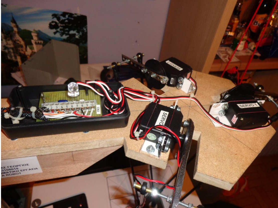
Εικόνα 3.2. Βάση στήριξης των servo.
