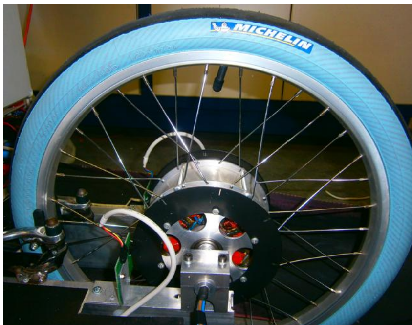
Σχήμα 6.16 – Τοποθέτηση του κωδικοποιητή θέσης και των αισθητήρων στον κινητήρα του οχήματος
