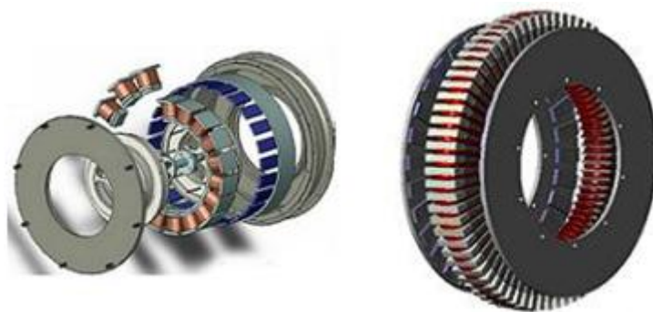
Σχήμα 2.3 - Μηχανές μονίμων μαγνητών ακτινικής ροής (αριστερά) και αξονικής (δεξιά) [33]
