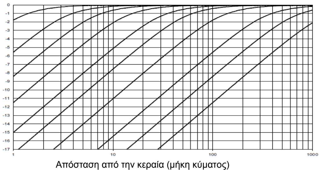
Σχήμα 4-6: Συντελεστής διόρθωσης για την περιοχή Fresnel για τετάρτου βαθμού συνημιτονοειδή φωτισμό (ορθογώνιο άνοιγμα)
