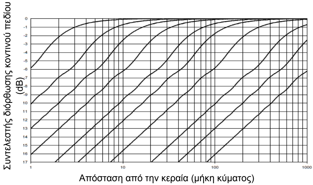
Σχήμα 4-3: Συντελεστής διόρθωσης για την περιοχή Fresnel για συνημιτονοειδή φωτισμό (ορθογώνιο άνοιγμα)
