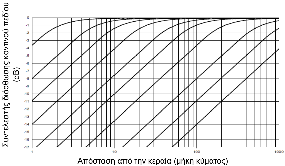
Σχήμα 4-4: Συντελεστής διόρθωσης για την περιοχή Fresnel για τετράγωνο συνημιτονοειδή φωτισμού (ορθογώνιο άνοιγμα)
