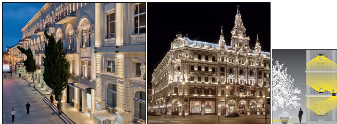
Εικόνα 3.20 : Φωτισμός τονισμού πρόσοψης κτιρίου με επιτοίχια φωτιστικά. Αριστερά: Budapest – Hungary: New York Pallace Budapest, δεξιά: Baku – Azerbaijan: Square, (Πηγή: External lighting systems, iGuzzini, 2011-2012).
