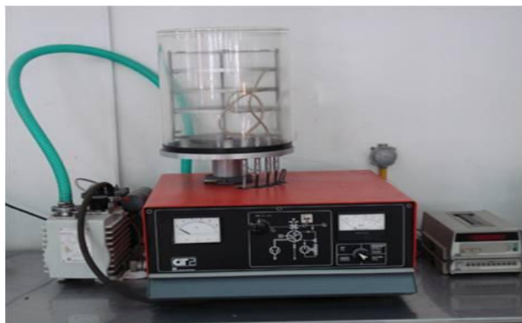
Εικόνα 6.1 Συσκευή ξήρανσης υπό κατάψυξη (Leybold-Heraeus GT 2A).
