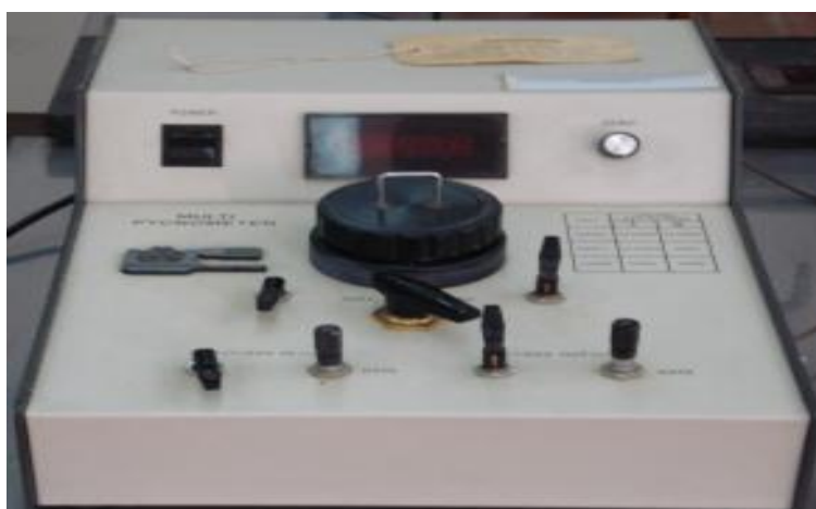
Εικόνα 6.2 Στερεοπυκνόμετρο ηλίου (Quantacrome multipycnometer MVP-1).
