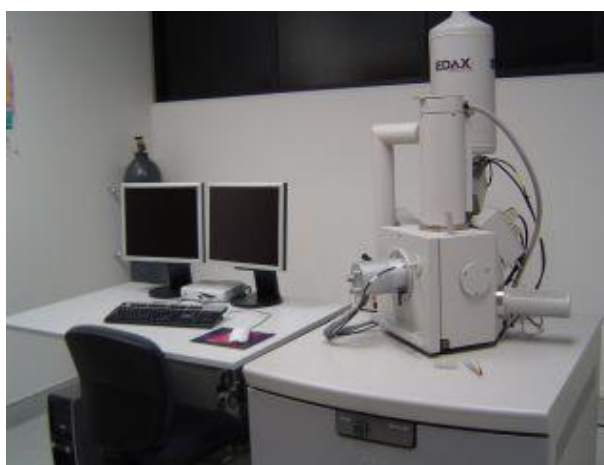
Εικόνα 2.8 Ηλεκτρονικό μικροσκόπιο σάρωσης (Quanta 200 FEI (2004),OR, USA).
