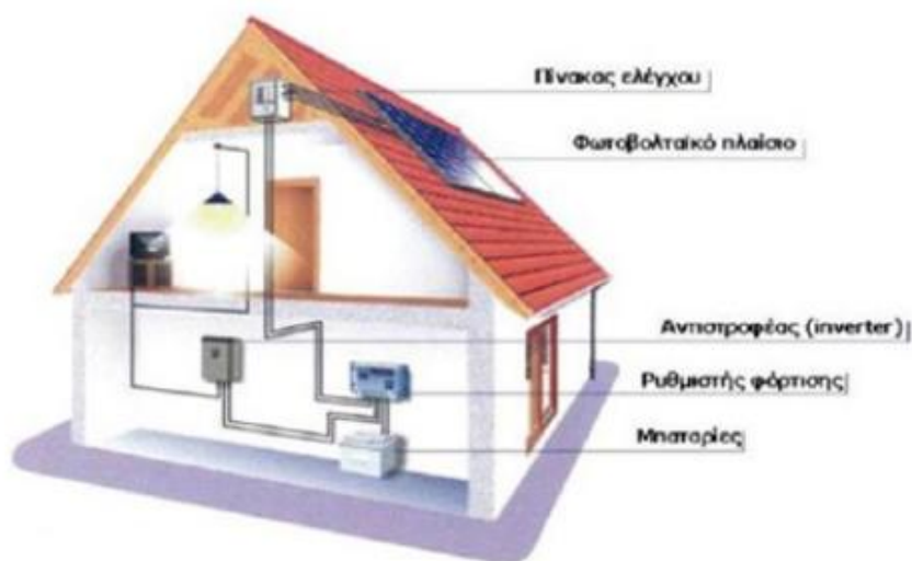
Σχήμα5.1: αυτόνομο φ/β σύστημα
