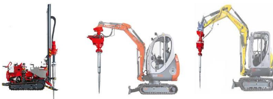
Μηχανήματα τοποθέτησης βιδωτών θεμελίων
