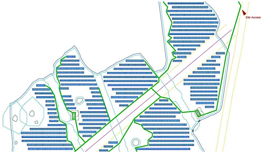
Σύστημα γείωσης πάρκου
