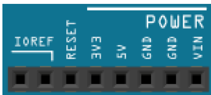
Εικόνα 41: Power pins of Arduino Mega ADK rev3
