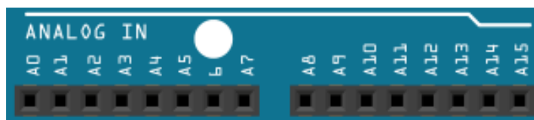
Εικόνα 42: Analog In pins of Arduino Mega ADK rev3
