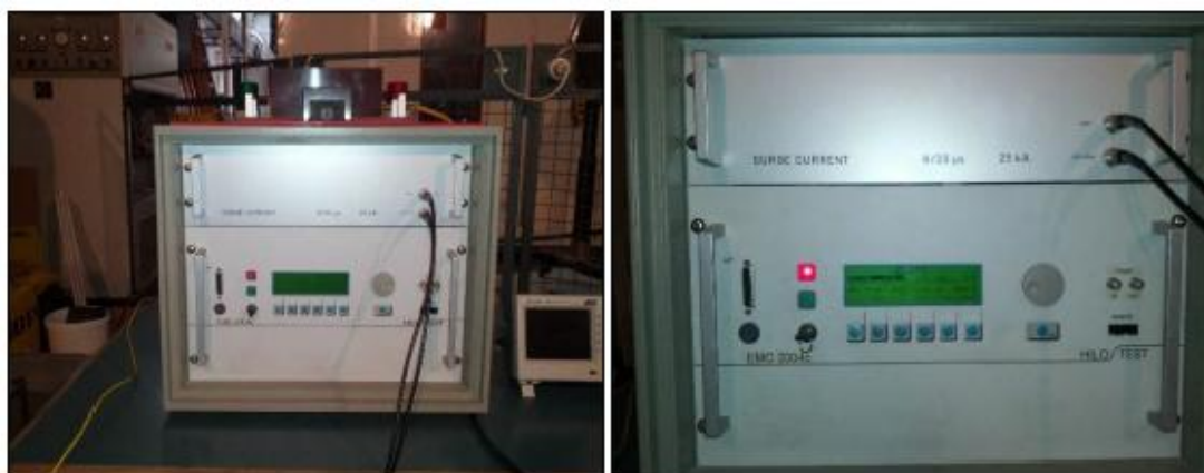
Εικόνα 4.5: Κρουστική γεννήτρια ρεύματος HILO-TEST:EMC-2004 [3]
