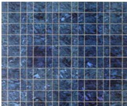
Σχήμα 3.2.6: Φωτοβολταϊκό στοιχείο πολυκρυσταλλικού πυριτίου.
