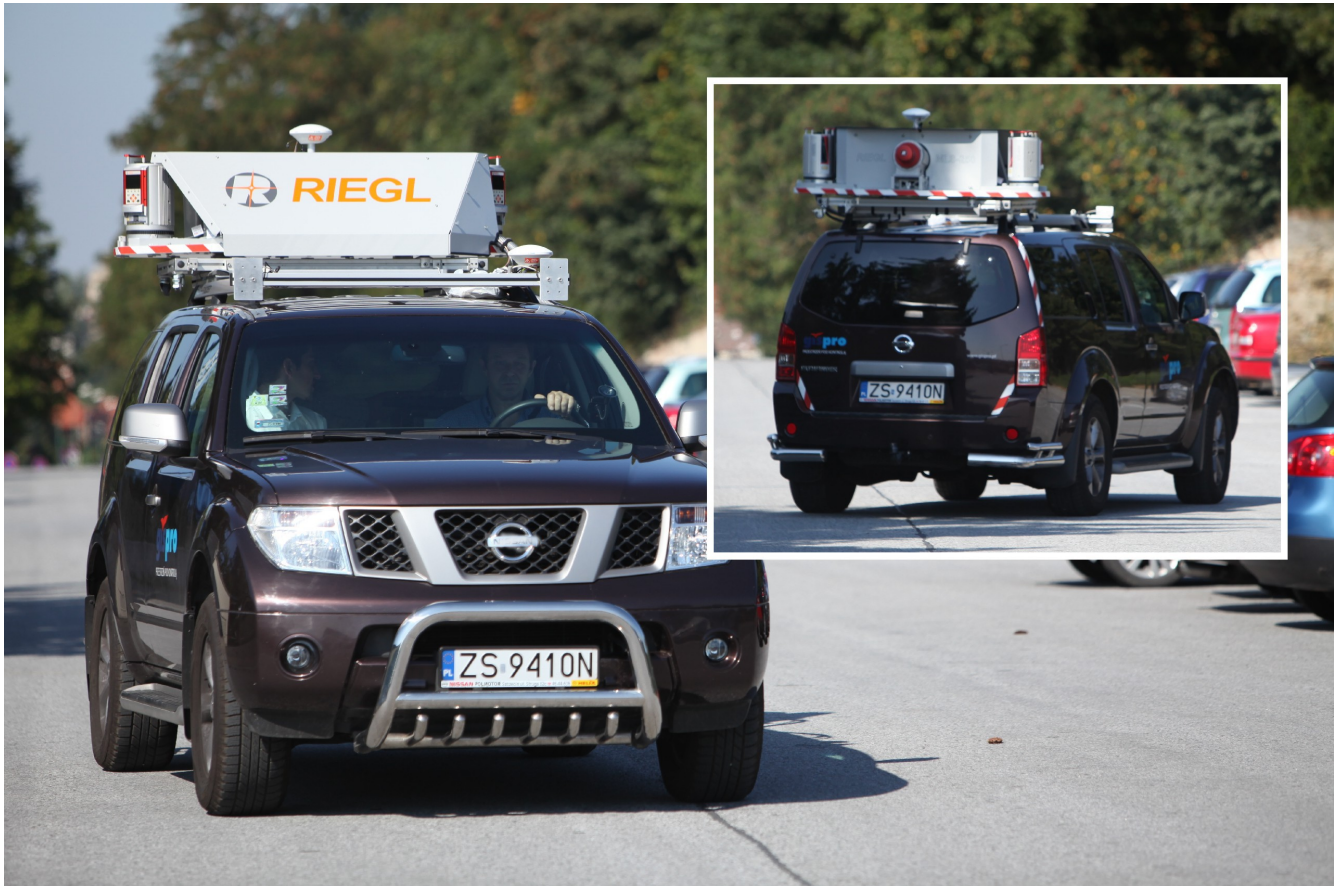
Σχήμα 22: Κινούμενος τρισδιάστατος σαρωτής προσαρτημένος σε αυτοκίνητο
