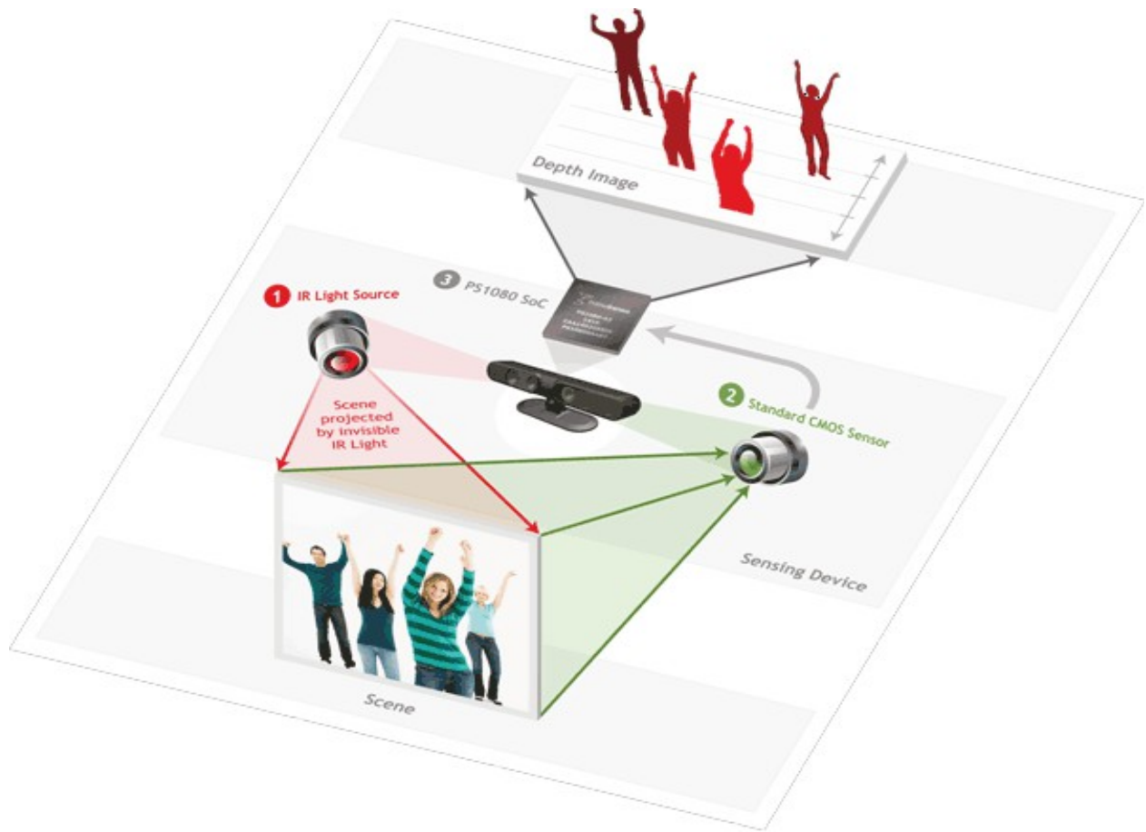
Σχήμα 29: Σχηματική αναπαράσταση της λειτουργίας του αισθητήρα Kinect
