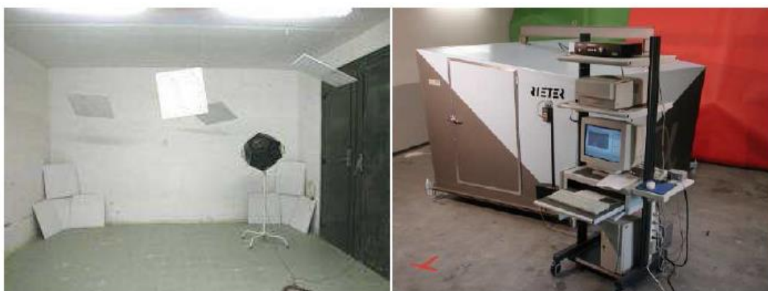
ΕΙΚΟΝΑ 5.7 ΔΥΟ ΠΑΡΑΔΕΙΓΜΑΤΑ ΑΝΤΗΧΗΤΙΚΩΝ ΘΑΛΑΜΩΝ. ΑΡΙΣΤΕΡΑ: ΜΕΓΑΛΟ ΔΩΜΑΤΙΟ ΜΕ ΠΑΝΚΑΤΕΥΘΥΝΤΙΚΗ ΠΗΓΗ ΚΑΙ ΑΝΑΚΛΑΣΤΗΡΕΣ. ΔΕΞΙΑ: ΘΑΛΑΜΟΣ ALPHA
