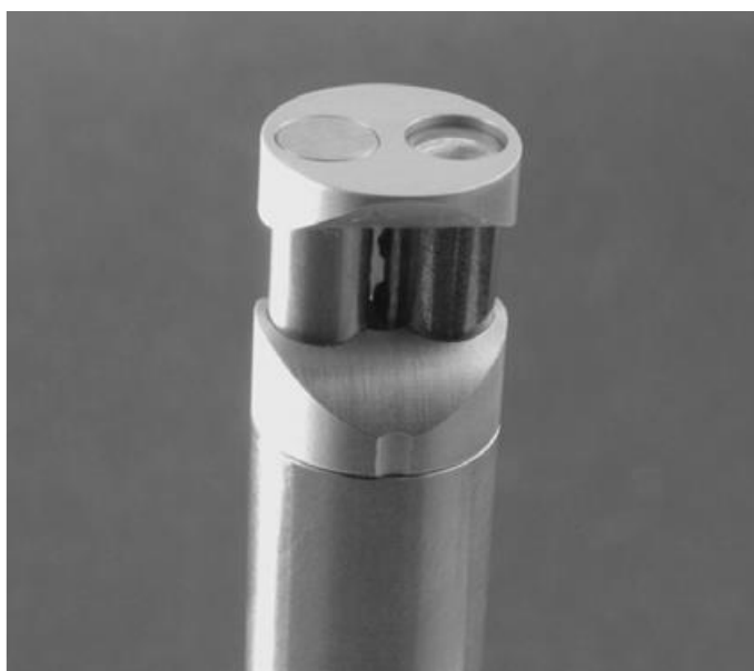
ΕΙΚΟΝΑ 3.8 Ένα ½-INCH SOUND INTENSITY PROBE ΤΗΣ MICROFLOW ®
