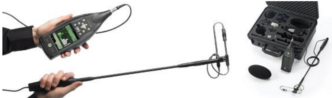
ΕΙΚΟΝΑ 3.1 TO HAND-HELD SOUND INTENSITY SYSTEM - TYPE 2270 G ΤΗΣ BRÜEL&KJÆR
