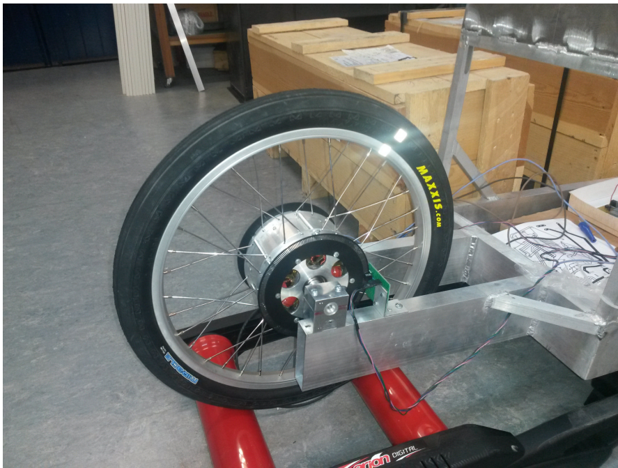
Σχήμα 2.3 Ο κινητήρας ενσωματωμένος στο τροχό
