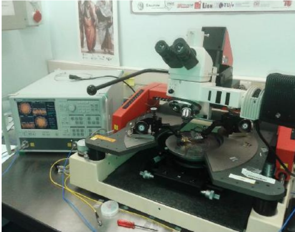
Σχήμα 3.4 Σταθμός οπτοηλεκτρονικών μετρήσεων (rf probe station) εργαστηρίου. Αριστερά φαίνεται ο Διανυσματικός Αναλυτής Δικτύου (VNA).
