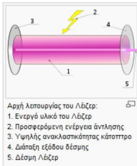
Σχήμα A.2 Αρχή λειτουργίας του laser [45]
