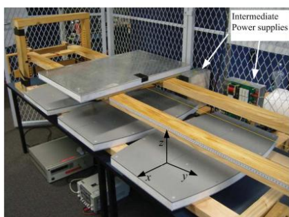
Σχήμα 1. 21: Δυναμικός σταθμός φόρτισης με πολλά πρωτεύοντα [29].
