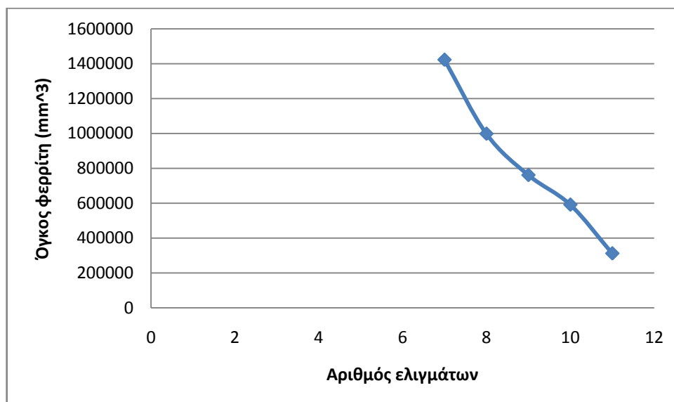
Διάγραμμα 5. 15: Απαιτούμενος όγκος φερρίτη ανάλογα με τον αριθμό των ελιγμάτων για τη διάταξη με εξωτερική διάμετρο φερρίτη 600mm και διάκενο 100mm.
