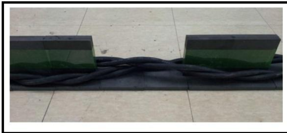
Σχήμα 1. 19: Περιστρεμμένα καλώδια για τη διάταξη X-rail [26].
