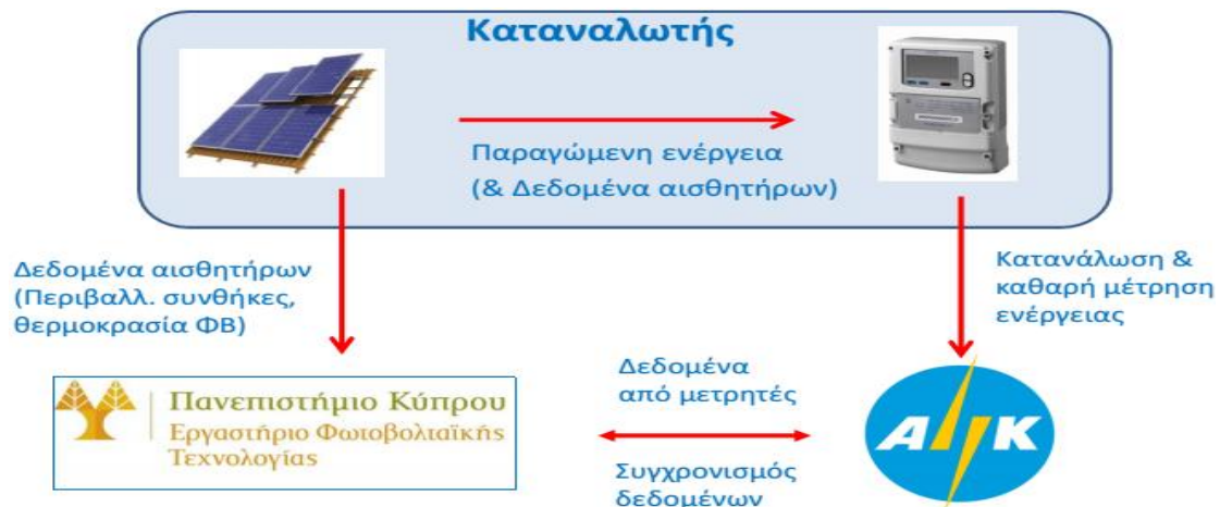
Σχήμα 5.4: Συλλογή δεδομένων από τις πιλοτικές εγκαταστάσεις net metering της Κύπρου ([89]).
