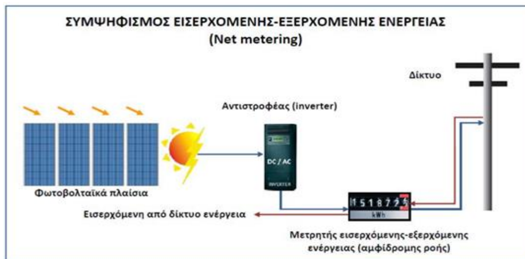
Σχήμα 4.1: Σύστημα net metering ([31]).
