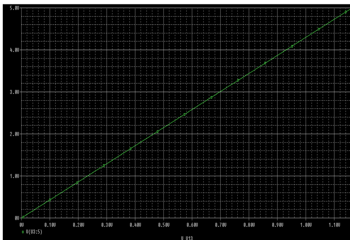
Σχ. 6.5: Τάση εξόδου μετά το δεύτερο στάδιο ενίσχυσης του ενισχυτή οργάνων.
