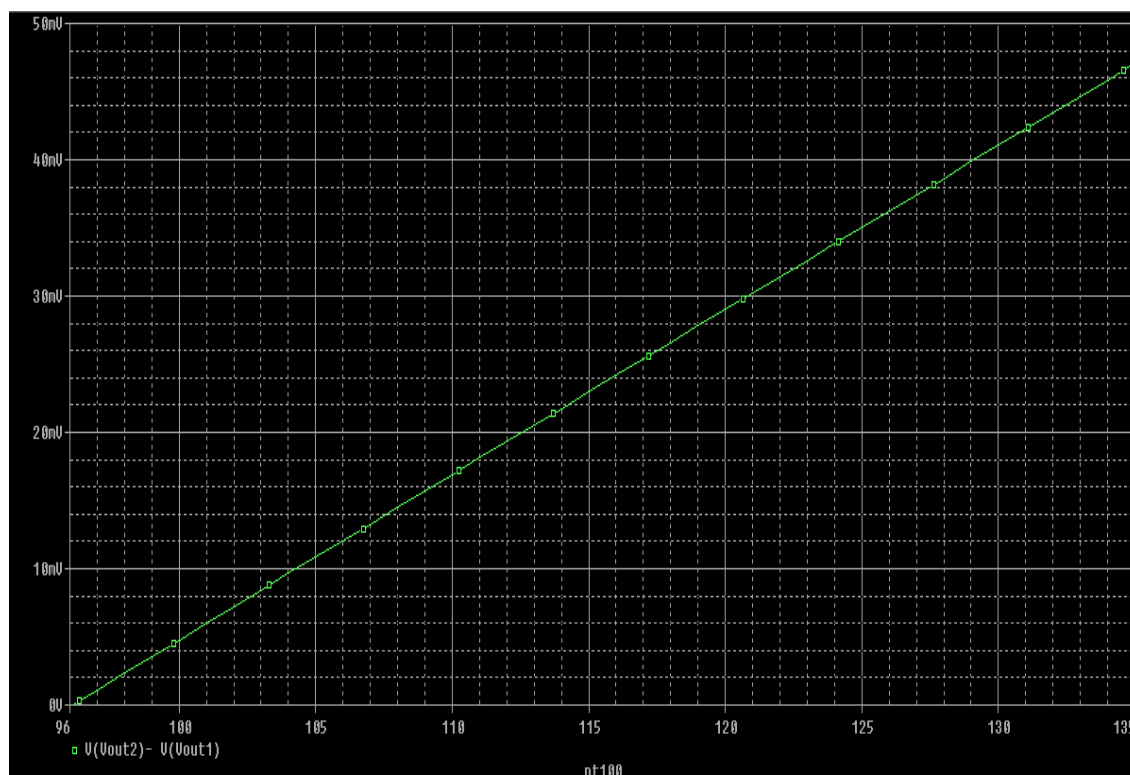
Σχ. 6.3: Τάση εξόδου της γέφυρας Wheatstone.
