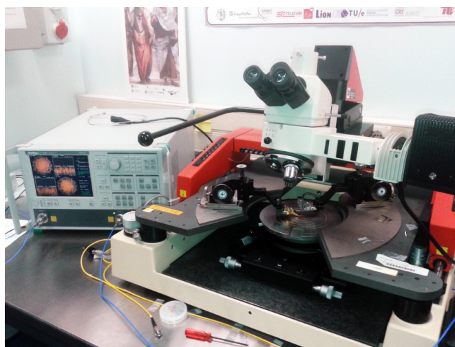
Σχήμα 4.11: Η πλατφόρμα δοκιμών: Αριστερά ο VNA, στο κέντρο ο probe station και από πάνω το οπτικό μικροσκόπιο
