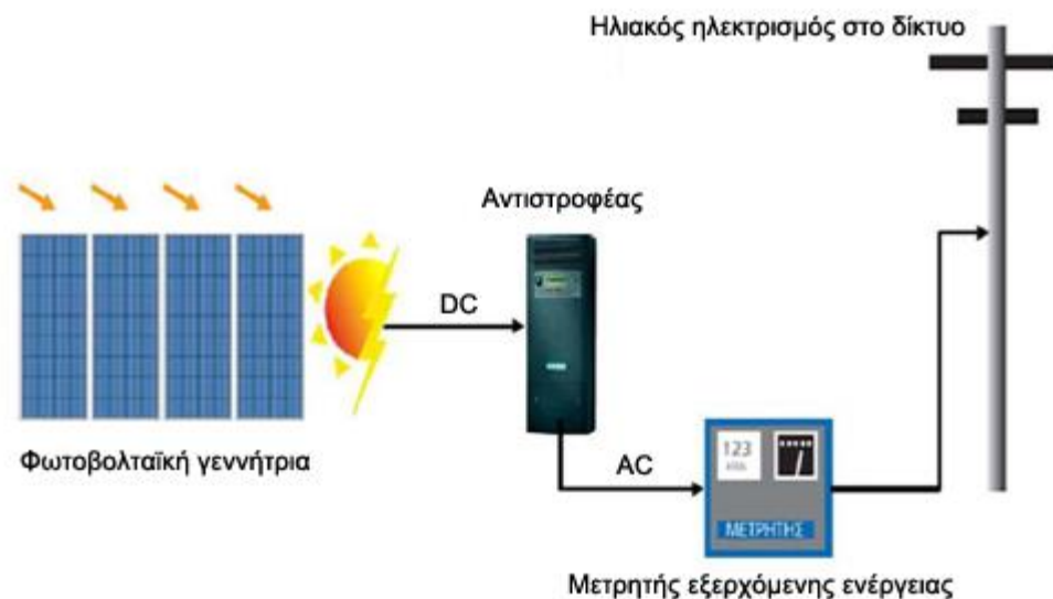
Σχήμα 15: Σύνδεση Φωτοβολταϊκών στο Δίκτυο [37]
