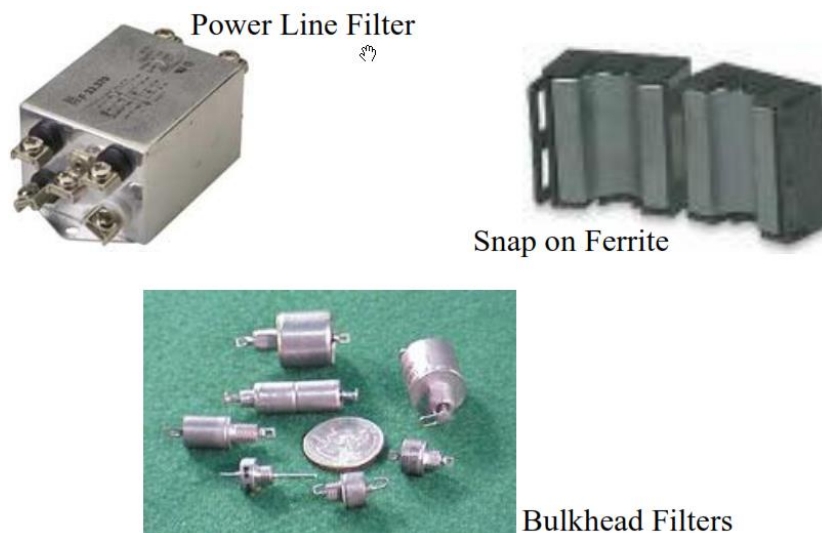
Σχήμα 4.30 – Ειδικές κατασκευές για ελαχιστοποίηση ηλεκτρομαγνητικής παρεμβολής
