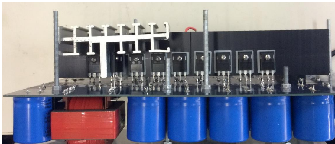
Σχήμα 7.4 – Πλάγια όψη πλακέτας #1 (PCB) μετατροπέα ισχύος με σύστημα ψύξης
