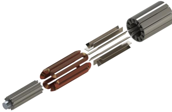
Εικόνα 24: Ανάλυση των μερών της Μηχανής Εναλλασσόμενης Ροής Τοπολογία τύπου «πυρήνα C». Από αριστερά προς τα δεξιά διακρίνονται, ο δρομέας, τα τυλίγματα, οι μαγνήτες και ο στάτης.
