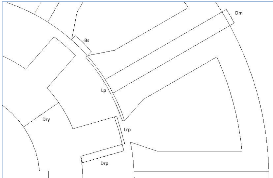
Εικόνα 27: Απεικόνιση των διαστάσεων που χρησιμοποιούνται στη σχεδίαση μέσω της μεθόδου Taguchi
