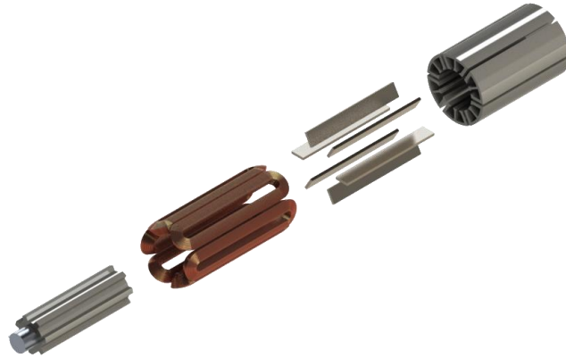
Εικόνα 294: Ανάλυση των μερών της Μηχανής Εναλλασσόμενης Ροής Τοπολογία τύπου «πυρήνα Ε». Από αριστερά προς τα δεξιά διακρίνονται, ο δρομέας, τα τυλίγματα, οι μαγνήτες και ο στάτης.
