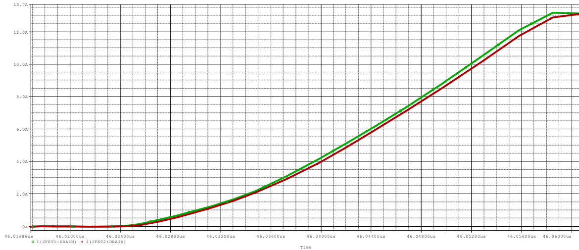
Σχήμα 8.2: Κυματομορφές ρευμάτων έναυσης των normally-on JFET1 (πράσινο χρώμα) και JFET2 (κόκκινο χρώμα) με παράσιτη αυτεπαγωγή LDS2=50nH.
