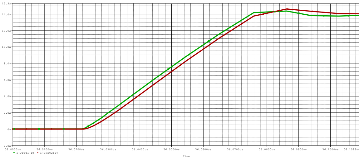
Σχήμα 8.6: Κυματομορφές ρευμάτων έναυσης των normally-off JFET1 (πράσινο χρώμα) και JFET2 (κόκκινο χρώμα) με παράσιτη αυτεπαγωγή L_{DS2}=50\text{nH} .
