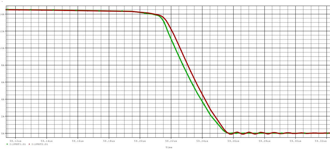
Σχήμα 8.7: Κυματομορφές ρευμάτων σβέσης των normally-off JFET1 (πράσινο χρώμα) και JFET2 (κόκκινο χρώμα) με παράσιτη αυτεπαγωγή L_{DS2}=50\text{nH} .
