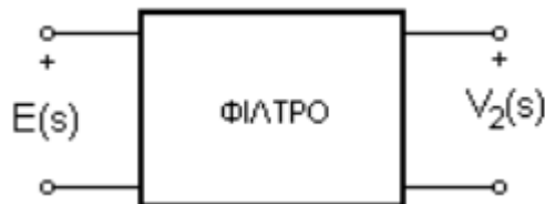
Σχήμα 2.1.1: Φίλτρο σε μορφή δίθυρου κυκλώματος
