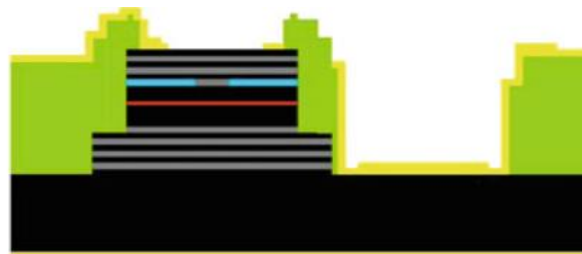
(i) Τοποθέτηση των GSG επαφών
