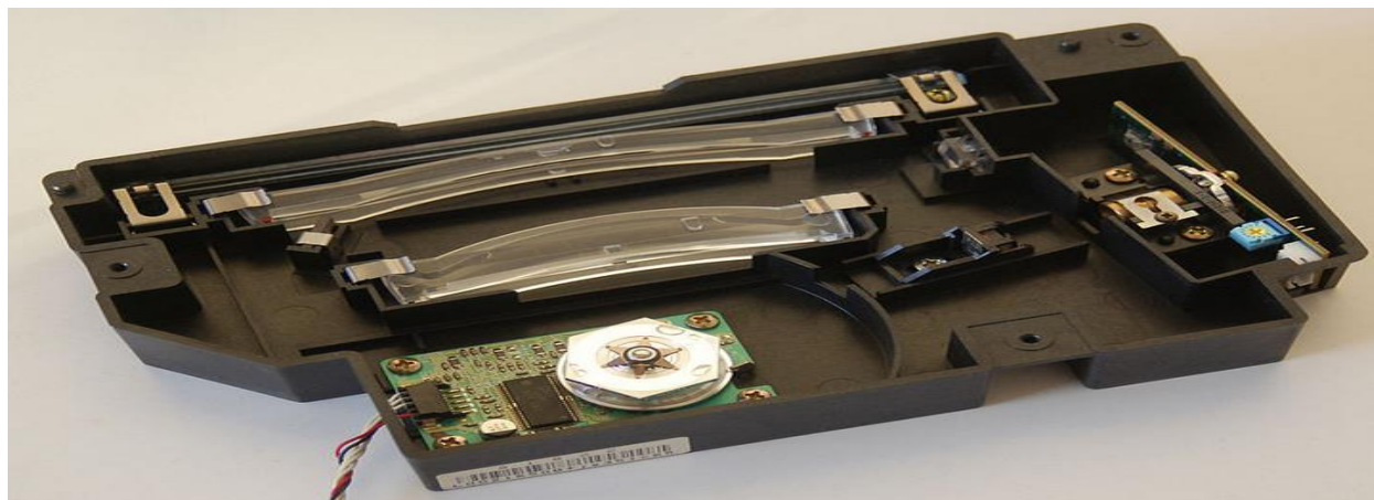
Εικόνα 5.11: Δομή λέιζερ μέσα σε ένα εκτυπωτή
