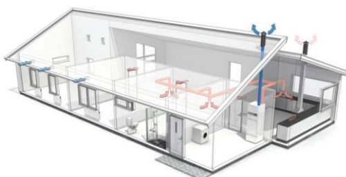
Εικόνα 2.8: Εικονογράφηση αντλία θερμότητας εξάτμισης αέρα/νερού
