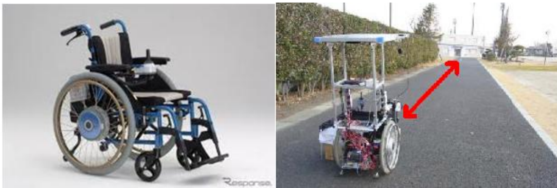
Εικόνα 6.1 : Τροποποιημένο αμαξίδιο που χρησιμοποιεί τρεις πηγές ενέργειας για την κίνηση του
