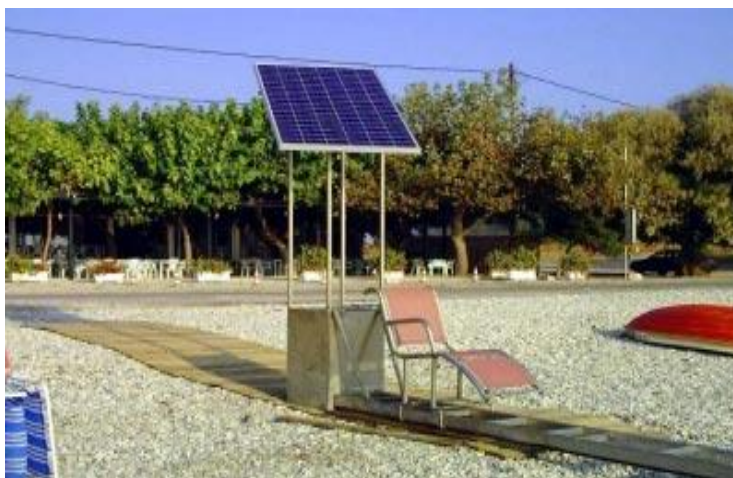
Εικόνα 3.14 : Χρήση Α.Π.Ε στη μηχανολογική διάταξη του SEATRAC™
