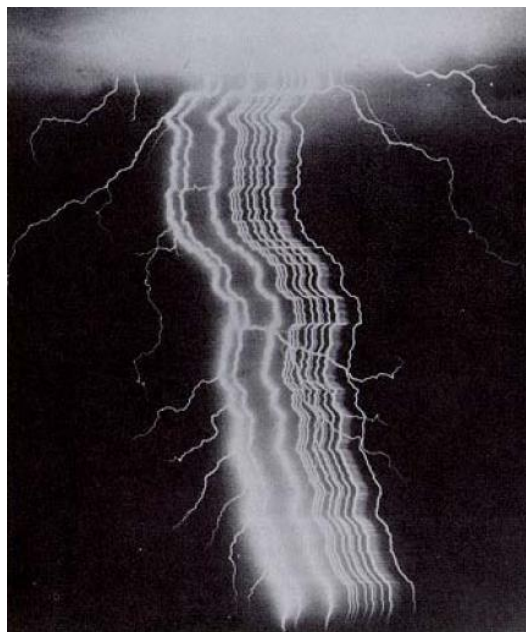
Εικόνα 1.14: Φωτογραφία κεραυνού με Streak-camera στην οποία διακρίνονται δώδεκα διαδοχικά κτύπηματα από τ' αριστερά προς τα δεξιά.. Η συνεχής εκπομπή φωτός μετά το ενδέκατο κτύπημα υποδηλώνει τη συνεχή ροή ρεύματος, για κάποιο χρονικό διάστημα, μετά από αυτό το κτύπημα [9].
