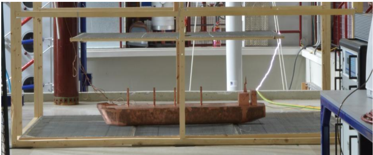
ΠΑΡΑΡΤΗΜΑ Ζ: Απόσταση «τοροειδούς»-μεταλλικής πλάκας D=75\text{cm} , Θετική Πολικότητα.
