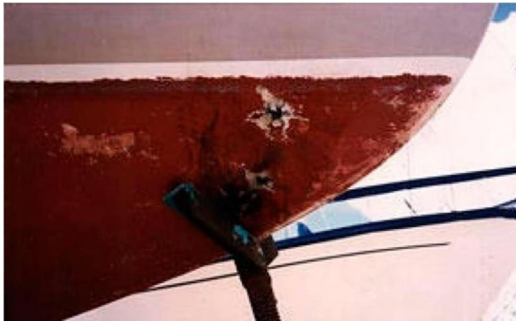
Εικόνα 2.1: Εκτεταμένες βλάβες στο κουφάρι πλοίου λόγω ανάπτυξης παράπλευρων εκκενώσεων μεταξύ της αλυσίδας της άγκυρας και του νερού [14].
