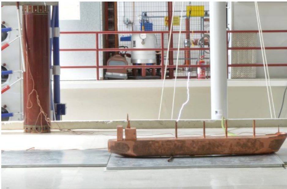
ΠΑΡΑΡΤΗΜΑ Γ: Απόσταση φορτισμένης ράβδου-μεταλλικής πλάκας D=75\text{ cm} , Θετική Πολικότητα.
