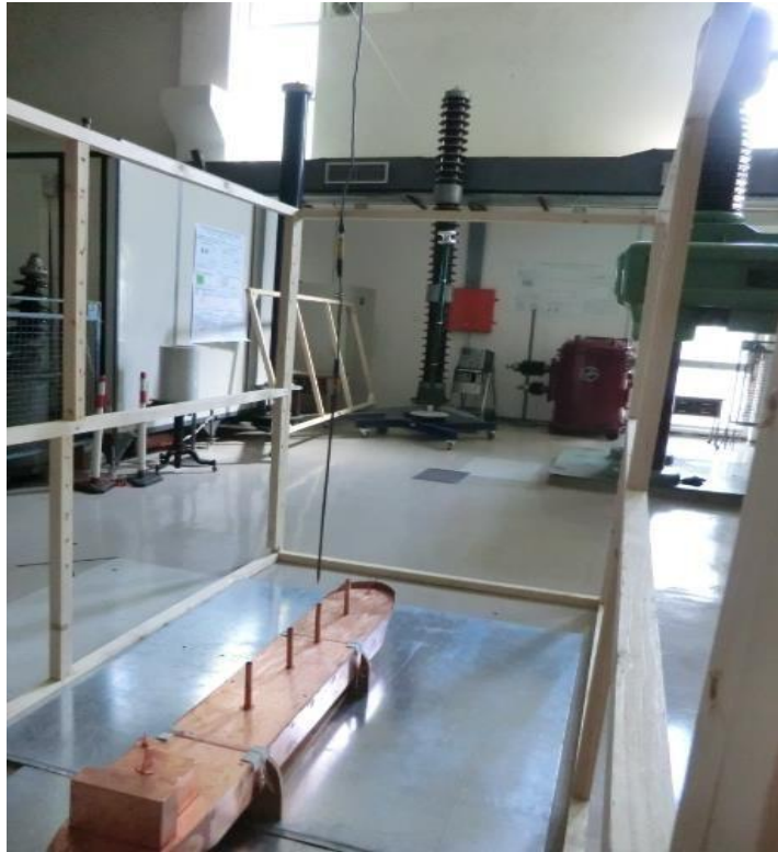
Εικόνα 4.6: Στην εικόνα φαίνονται το μοντέλο πλοίου, η μεταλλική πλάκα, η ράβδος και η ξυλοκατασκευή για το «τοροειδές».
