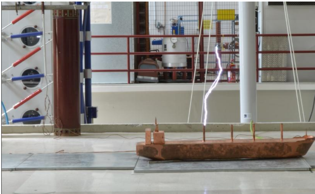
ΠΑΡΑΡΤΗΜΑ Β: Απόσταση φορτισμένης ράβδου-μεταλλικής πλάκας D=100\text{ cm} , Αρνητική Πολικότητα.
