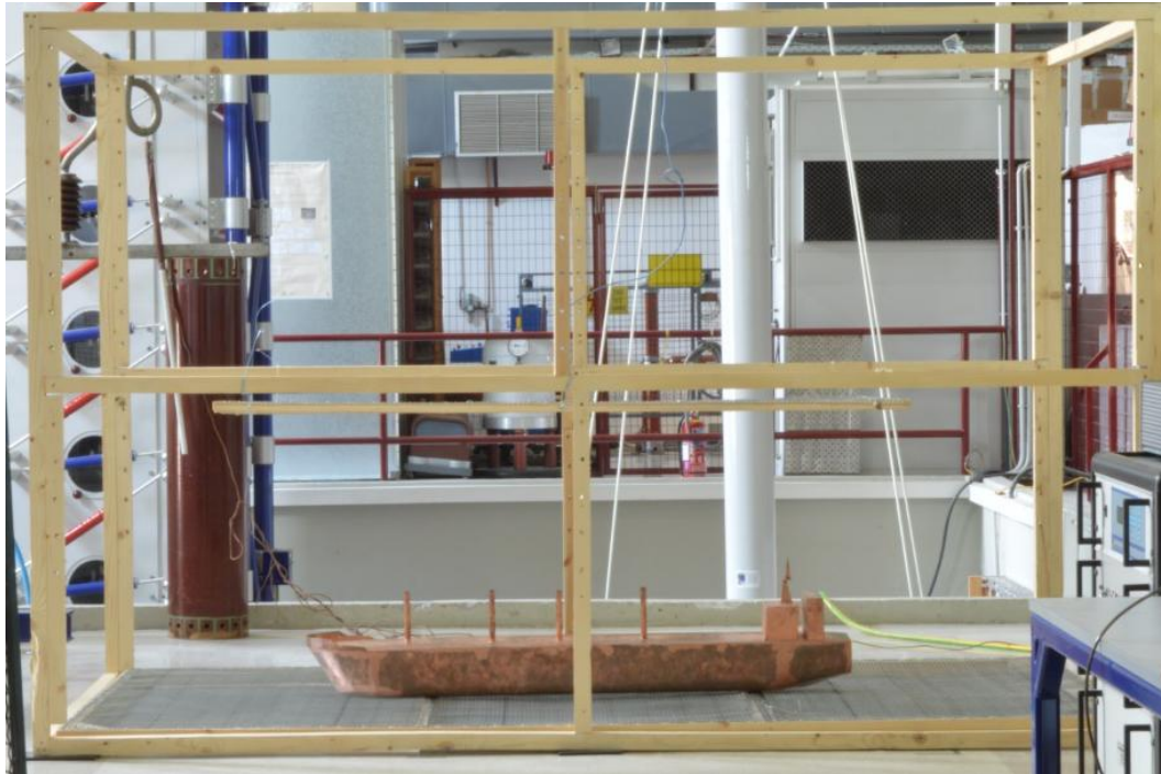
Εικόνα 4.11: Στο σχήμα φαίνονται το μοντέλο πλοίου ,η γειωμένη μεταλλική πλάκα και το «τοροειδές».
