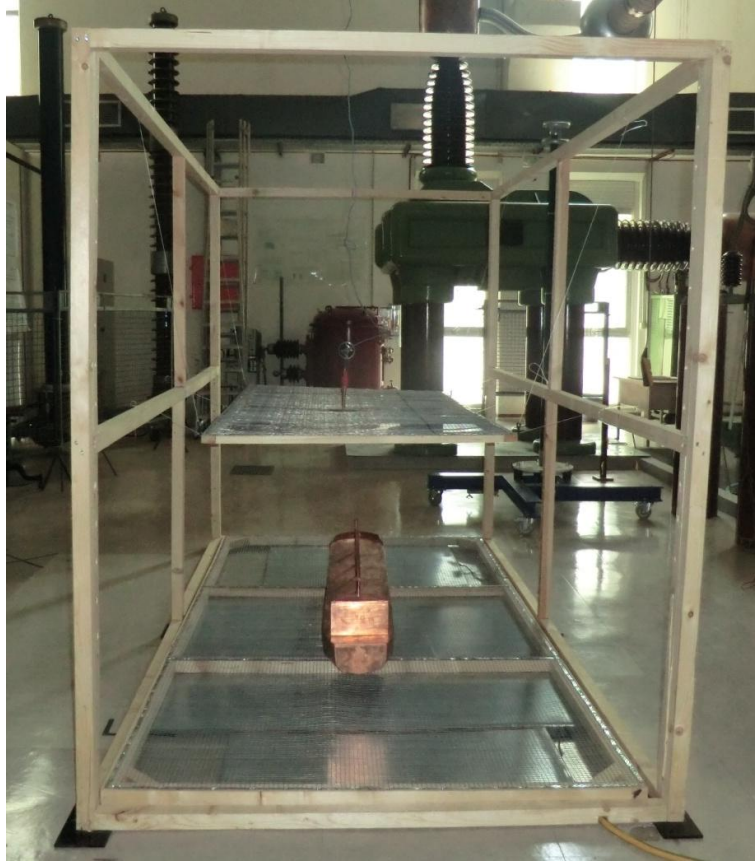
Εικόνα 4.8: Στο σχήμα φαίνονται το μοντέλο πλοίου, η μεταλλική πλάκα, η ράβδος και η ξυλοκατασκευή με το «τοροειδές».
