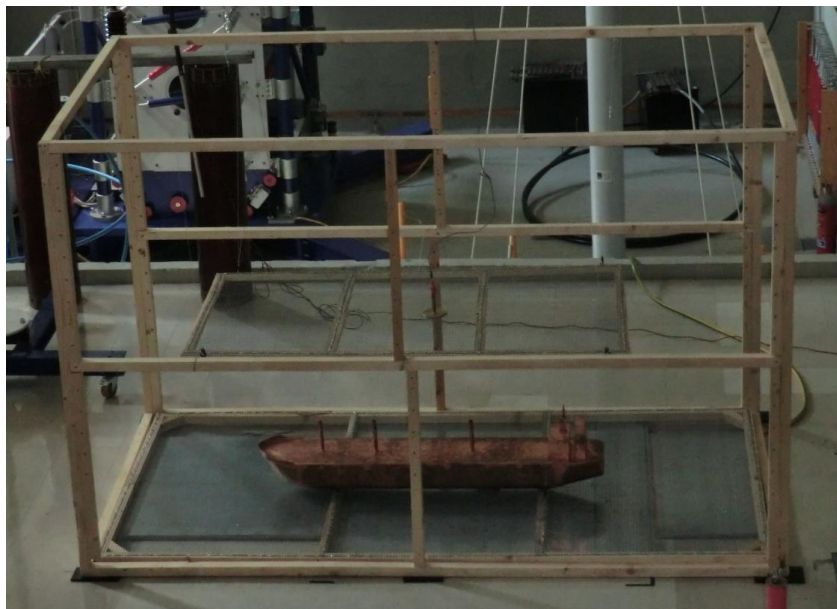
Εικόνα 4.7: Στο σχήμα φαίνονται το μοντέλο πλοίου, η μεταλλική πλάκα, η ράβδος και η ξυλοκατασκευή με το «τοροειδές».
