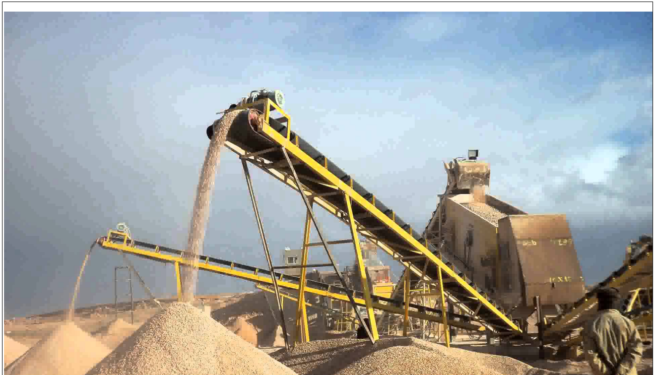
Παράδειγμα Συστήματος θραύσης & Διαβάθμισης ορυκτού περλίτη [31]
