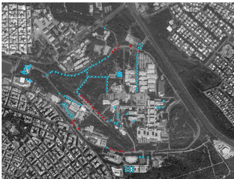
Σχήμα 27 – Φωτιστικά της 2 ης ομάδας φωτιστικών με λαμπτήρες ατμών νατρίου υψηλής πίεσης (κόκκινο χρώμα)
