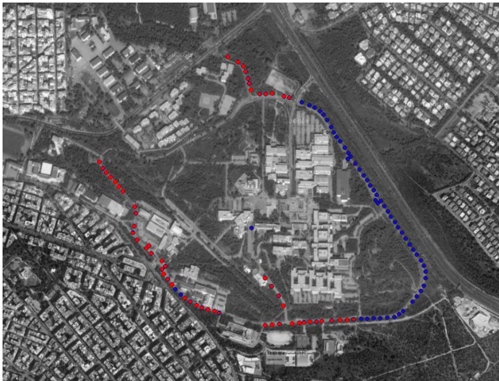
Σχήμα 38 - Φωτιστικά της 1 ης ομάδας φωτιστικών με λαμπτήρες ατμών νατρίου χαμηλής πίεσης (κόκκινο χρώμα)
