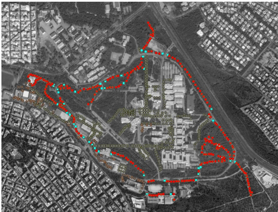
Σχήμα 75 – Φωτιστικά στα οποία θα τοποθετηθούν αισθητήρες
