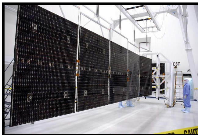
Εικόνα 3.14: Ηλιακοί συλλέκτες Γαλλίου-Αρσενικούχου 10kW τριπλού κόμβου Πηγή: http://en.wikipedia.org/ [9]
