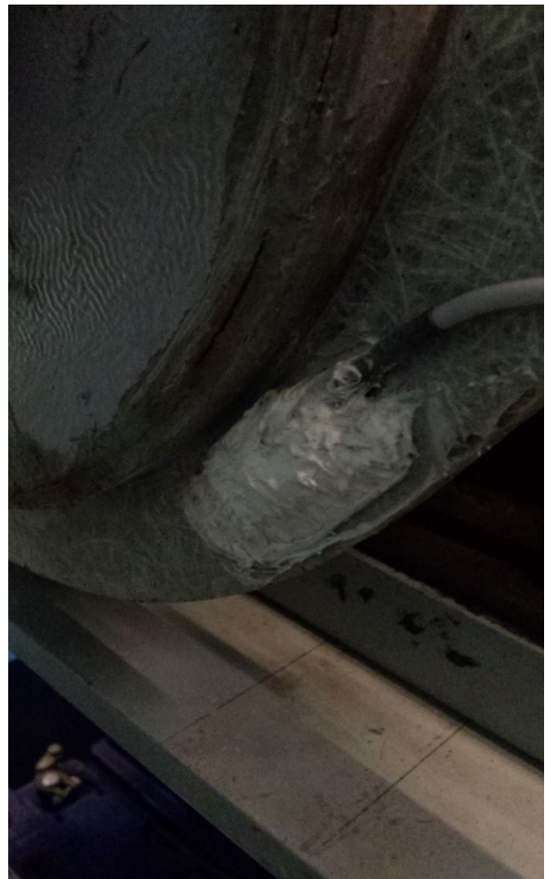
Εικόνα 5.5: Αισθητήρας θερμότητας στο στάτη.
