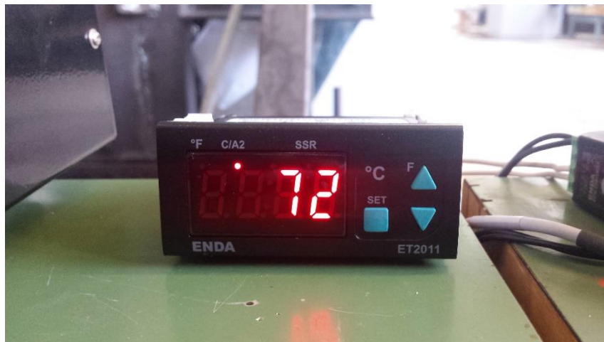
Εικόνα 5.2: Μέτρηση αισθητήρα θερμότητας στο τυλίγμα του χαλκού.
