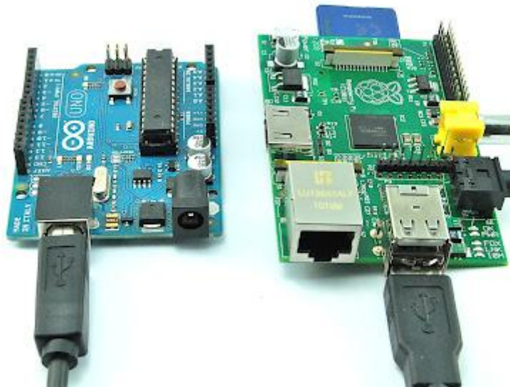
Εικόνα 9: Σύνδεση arduino και Raspberry Pi
