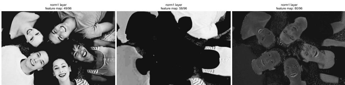
Σχήμα 5.11: Επιλεγμένοι χάρτες χαρακτηριστικών από το πρώτο επίπεδο κανονικοποίησης.
