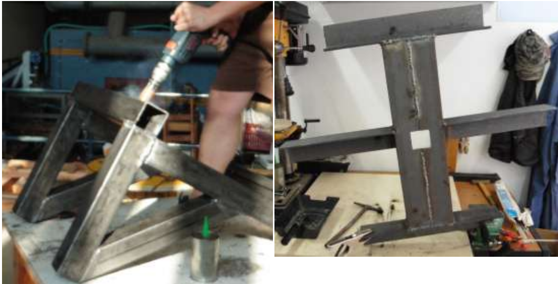
Σχήμα 7.15. Διαμόρφωση της κατασκευής στήριξης της γεννήτριας (δεξιά) και της βάσης στην οποία τοποθετήθηκε για την πραγματοποίηση των μετρήσεων (αριστερά)
