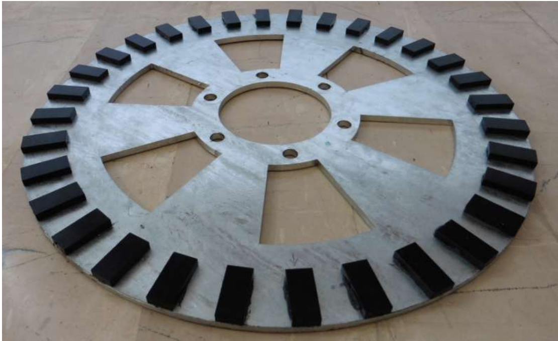
Σχήμα 7.3. Ο δίσκος μετά τη στερέωση των μαγνητών
