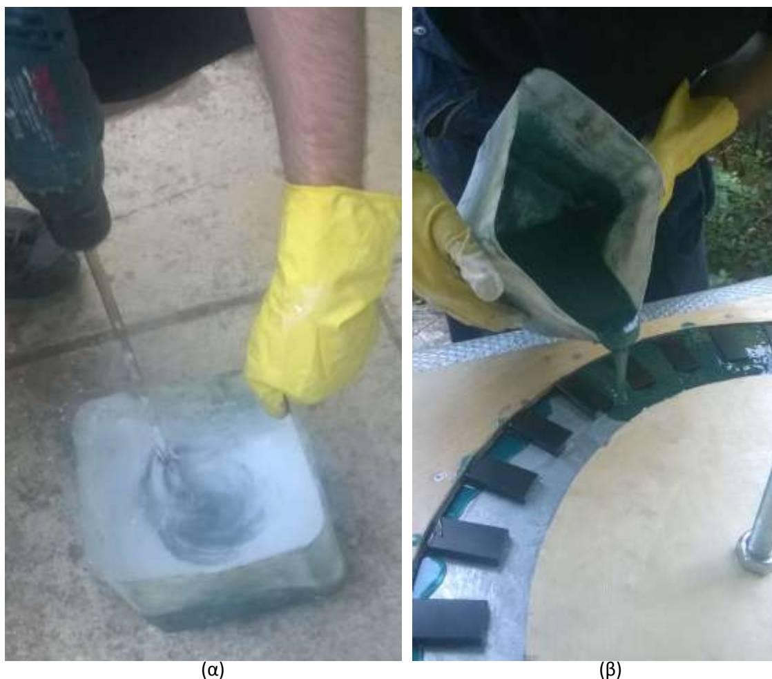
Σχήμα 7.4. α) Ανάμιξη ρητίνης, ταλκ και καταλύτη β) Έγχυση ρητίνης στο καλούπι
