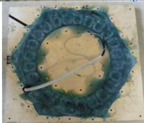
Σχήμα 7.12. Στην πρώτη εικόνα το καλούπι του στάτη έχει μόλις βιδωθεί. Στη δεύτερη έχουμε μόλις ανοίξει το καπάκι μετά από 8 ώρες αναμονής και η ρητίνη έχει στερεοποιηθεί.
