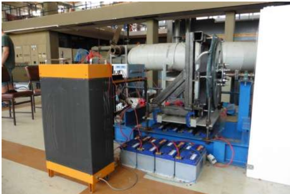
Σχήμα 8.6. Το ωμικό τριφασικό φορτίο 3kW μεταβλητής αντίστασης συνδεδεμένο παράλληλα με τις συστάδες των συσσωρευτών
