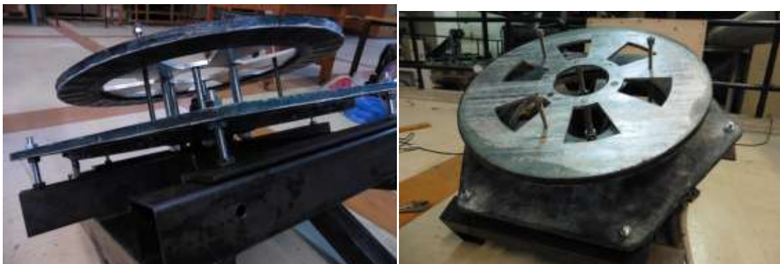
Σχήμα 7.16. Η διαδικασία συναρμολόγησης της γεννήτριας
