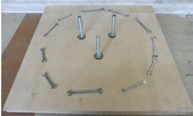
Σχήμα 7.5. Το καλούπι δε χρειάζεται βίδωμα, αρκεί η τοποθέτηση μεταλλικών εργαλείων που έλκονται από τους μαγνήτες και έτσι ασκείται η απαραίτητη πίεση ώστε να διαφύγει η πλεονάζουσα ρητίνη
