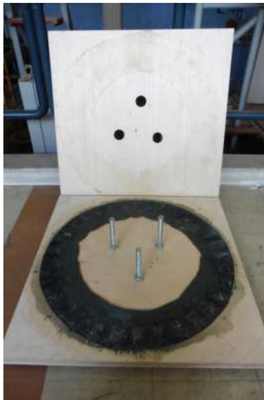
Σχήμα 7.6. Το καλούπι έχει μόλις ανοιχτεί. Είναι εμφανές ότι θα πρέπει να αφαιρεθεί η περιττή ρητίνη
