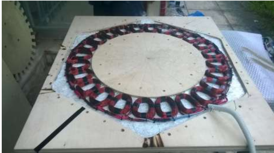
Σχήμα 7.11. Τα πηνία τοποθετημένα πάνω σε υαλόνημα μέσα στο καλούπι λίγο πριν την έγχυση της ρητίνης.
