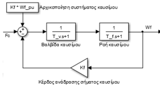
Σχήμα 2.12: Αναπαράσταση συστήματος καυσίμου στο πεδίο της μιγαδικής συχνότητας s
