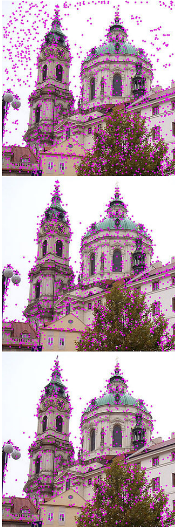
Σχήμα 1.1: Στην εικόνα αυτή φαίνονται τα σημεία ενδιαφέροντος που αναγνωρίζει ο αλγόριθμος εξαγωγής χαρακτηριστικών SIFT στην εικόνα.
