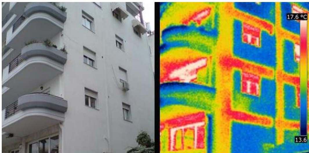
Εικόνα 3.2: Πολυκατοικία με προβληματική μόνωση
