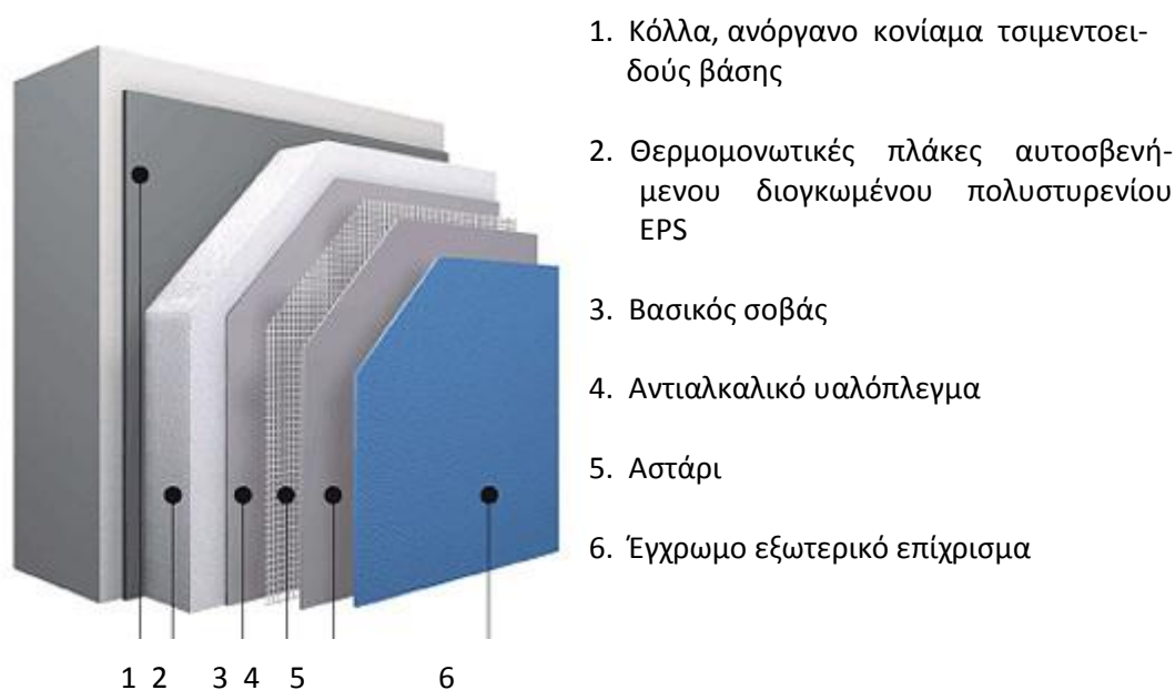
Εικόνα 4.9: Προτεινόμενη εξωτερική θερμομόνωση τοιχοποιίας
