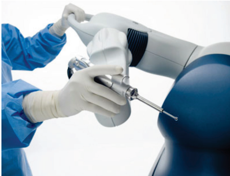
Εικόνα 22: Το υψηλής συχνότητας εργαλείο φρεζαρίσματος (μπερ) τοποθετημένο πάνω στο άκρο του βραχίονα του RIO [32]
