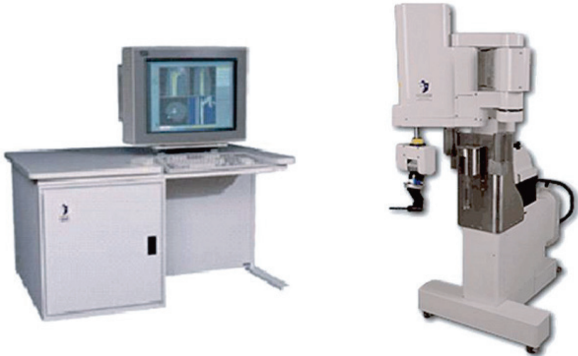
Εικόνα 18: Ο προεγχειρητικός σταθμός εργασίας OrthoDoc (αριστερά) και ο χειρουργικός βοηθός RoboDoc (δεξιά)[33]
