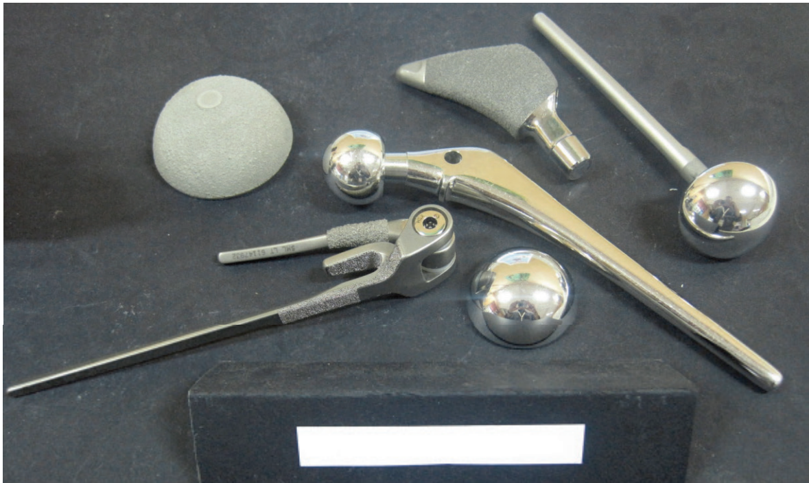
Εικόνα 11: Σετ εμφυτευμάτων αγκώνα και ισχίου από CoNiCrMo [21]
