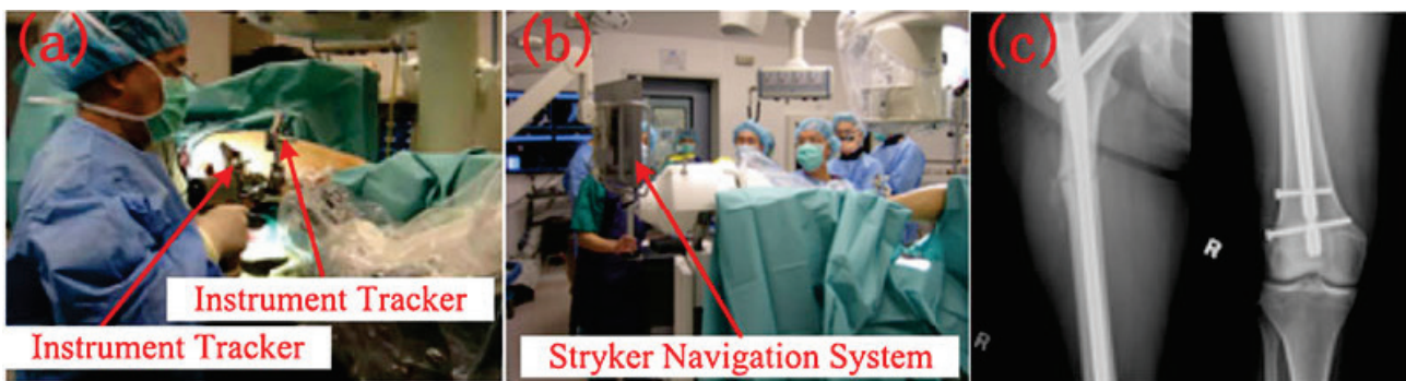
Εικόνα 34: Περιφερικό κλείδωμα με τη βοήθεια του ρομπότ HybriDot σε παθητική λειτουργία χρησιμοποιώντας σύστημα πλοήγησης Stryker [43]
