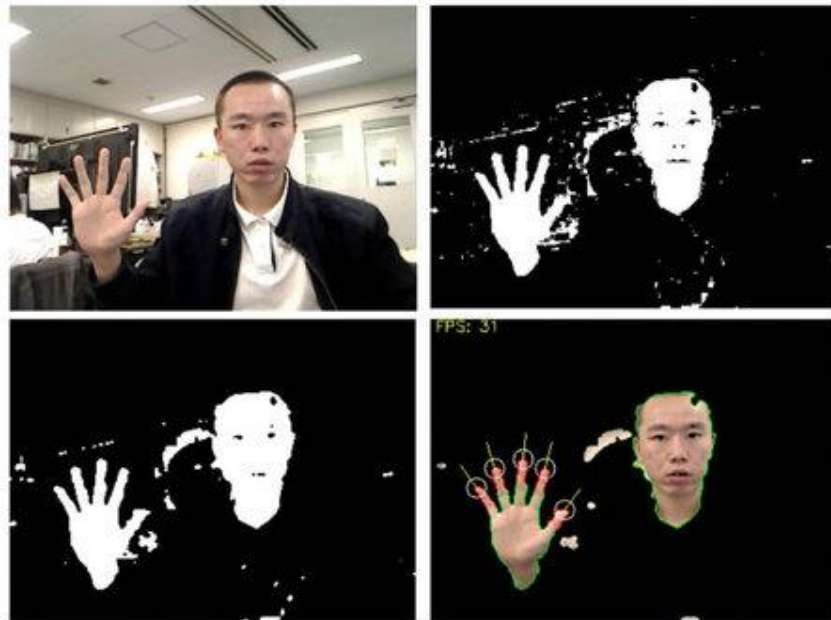
Ανίχνευση με βάση το χρώμα, του χεριού και του κεφαλιού ενός χρήστη με παράλληλη αποκοπή του φόντου
