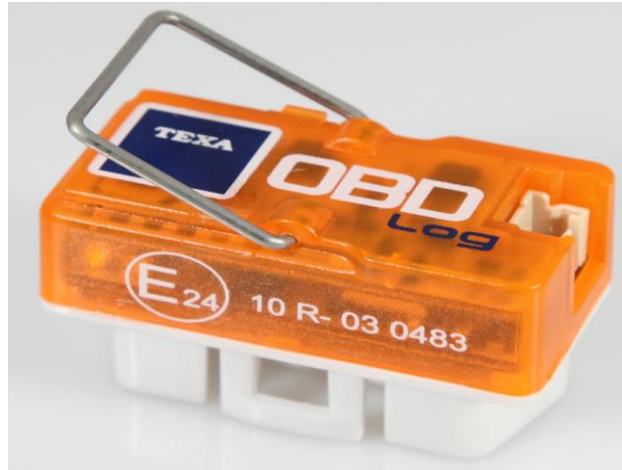
Εικόνα 17: TEXA OBD log. Μικρός καταγραφείς δεδομένων με τη δυνατότητα να διαβάζει τα δεδομένα αργότερα από υπολογιστή μέσω USB
