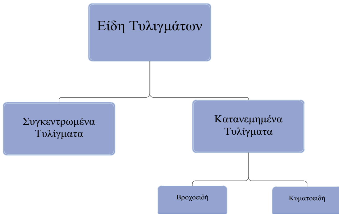
Σχήμα 3.14 : Τα διάφορα είδη τυλιγμάτων μηχανών εναλλασσομένου ρεύματος.
