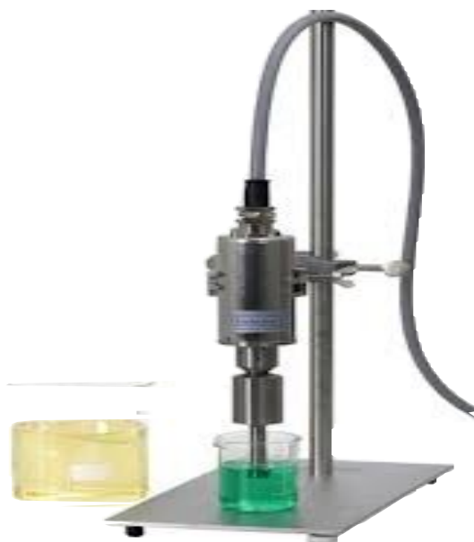
Εικόνα 4.1 Ομογενοποίηση του δείγματος
